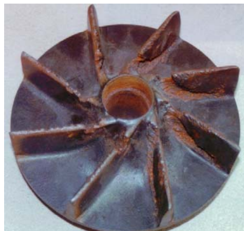
Sl. 10 Tragovi kavitacije na aksijalnom i radijalnom radnom kolu.
