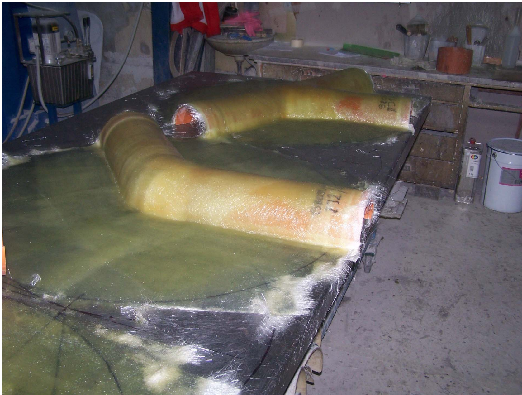
Izrada kineta od poliestera
