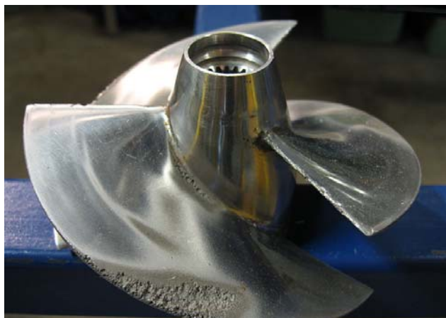
Sl. 10 Tragovi kavitacije na aksijalnom i radijalnom radnom kolu.
