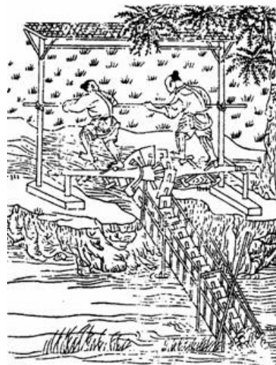
Sl. 3 Kineska lančana crpka s pravokutnim lopaticama, model i slika na drvorezu iz 1673. god.
