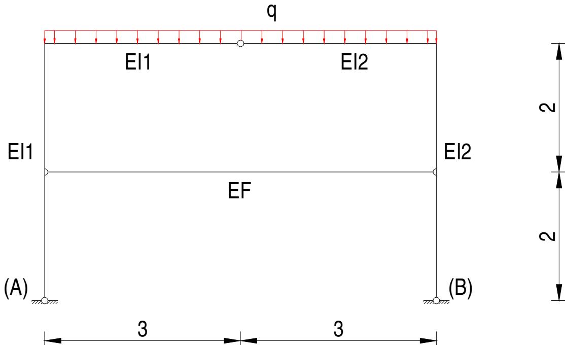
Određivanje statičke neodređenosti: zadani sustav u ravnini ima dva zgloba koji sprečavaju horizontalne i vertikalne pomake, tj imaju ukupno 4 veze.
