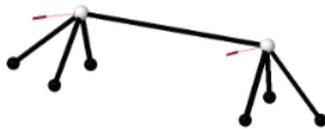
Naredbom maxwell\_rule pomoću Maxwellovog pravila određuje se nužan uvijet za statičku i kinematičku određenost sustava.
