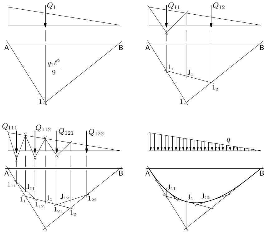
(rekurzivna) konstrukcija kvadratne parabole u dijagramu poprečnih sila:
