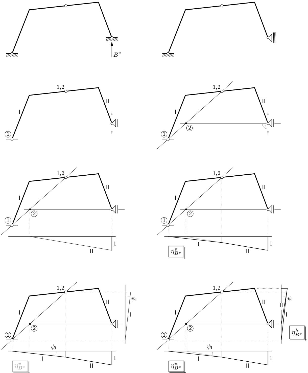
Nacrtajte UL za vertikalnu reakciju u lijevome ležaju!
