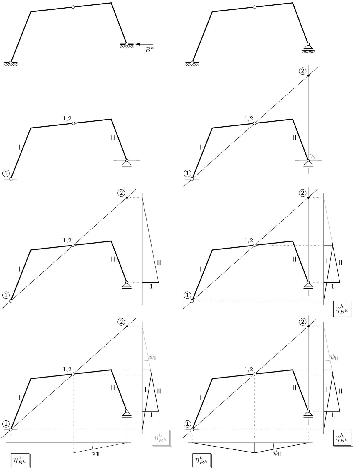
Nacrtajte UL za horizontalnu reakciju u lijevome ležaju!
