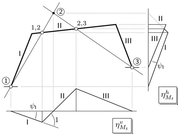
Nacrtajte UL za moment savijanja u presjeku desno od srednjega zgloba!
