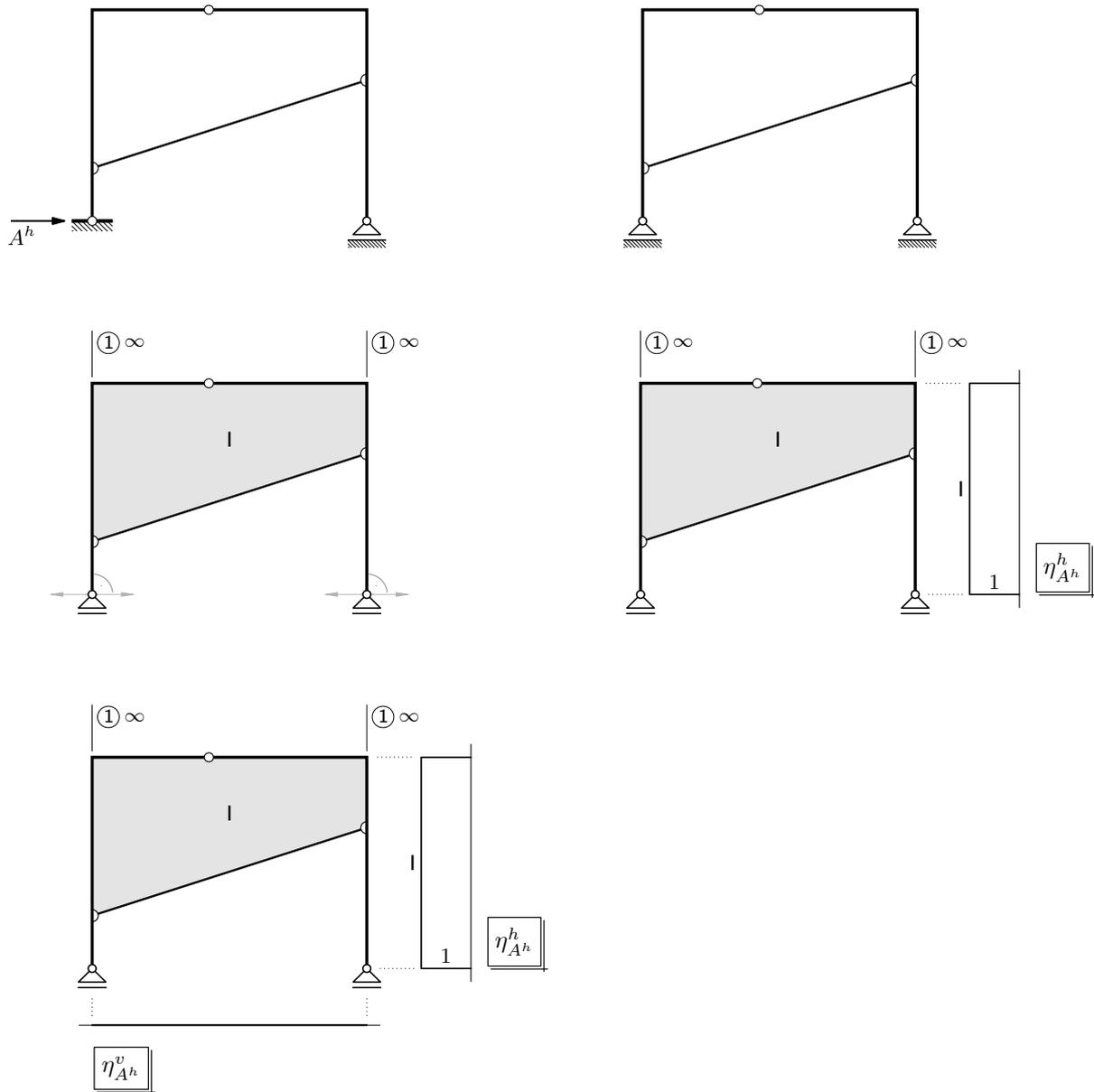
Nacrtajte UL za vertikalnu reakciju u lijevome ležaju!
