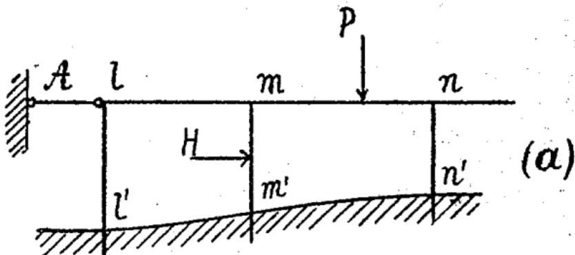
„Rastaviti ćemo našu zadaću u dva dijela. U prvom dijelu odrediti ćemo momente na krajevima pojedinih štapova, koji nastaju uslijed djelovanja vanjskih sila, te ćemo uz to prepostaviti, da je jedan čvor nosača spojen sa čvrstim tlom još pomoću horizontalnog štapa (štapa  $A$ ), te će radi toga pomaknuće u biti jednak nuli.”
