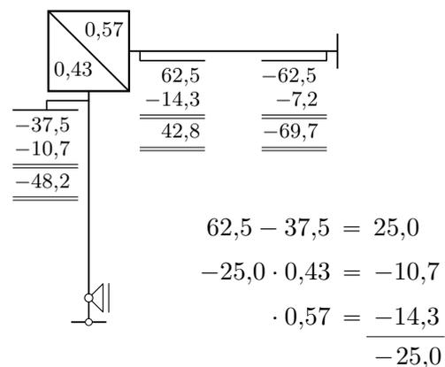
vrijednosti reakcija u zamišljenim spojevima:
