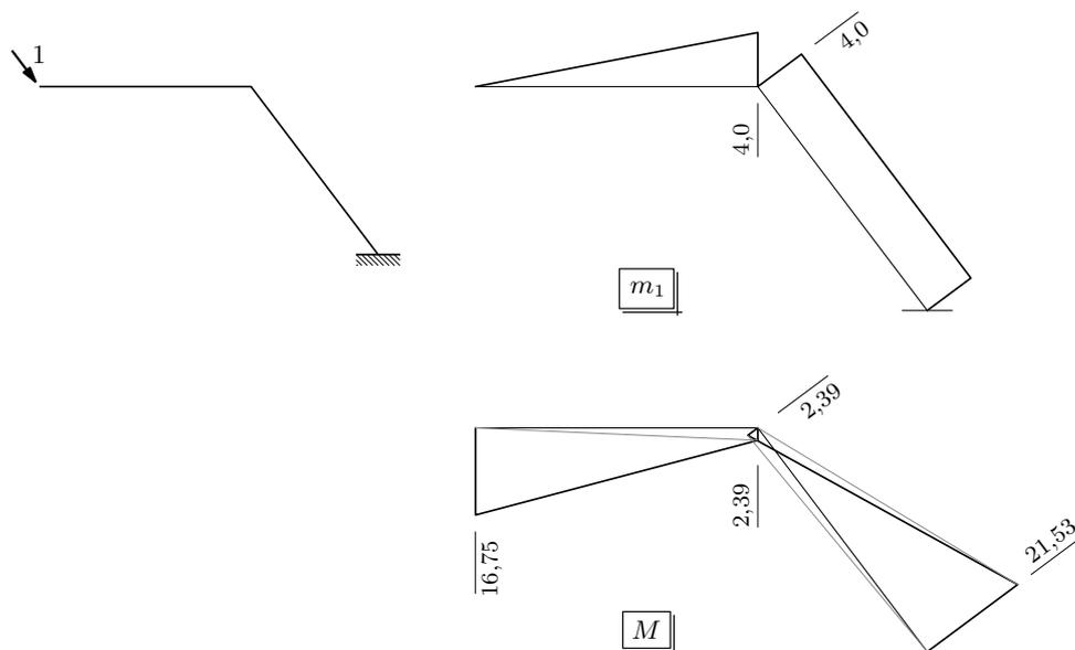
reduksijski stavak: jedinična sila na bilo kojem osnovnom sistemu za metodu sila
