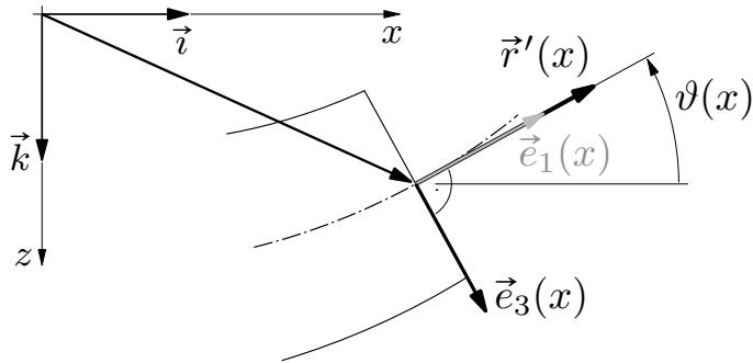
$$\vec{e}_1(x) = \cos \vartheta(x) \vec{i} - \sin \vartheta(x) \vec{k}$$
