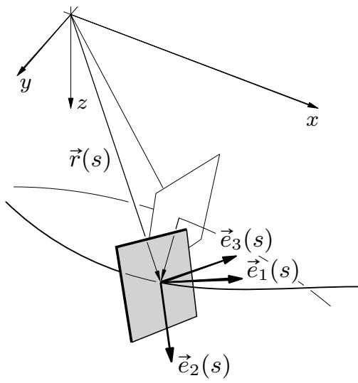
Vektori  $\vec{e}_{0,1}(s)$ ,  $\vec{e}_{0,2}(s)$ ,  $\vec{e}_{0,3}(s)$  pri pomicanju i deformiranju štapa prelaze u vektore  $\vec{e}_1(s)$ ,  $\vec{e}_2(s)$ ,  $\vec{e}_3(s)$ . Prema pretpostavci se ravnina poprečnoga presjeka ne deformira, pa su i vektori  $\vec{e}_2(s)$  i  $\vec{e}_3(s)$  jedinični i međusobno okomiti, a razapinju ravninu  $\omega(s)$  u koju je poprečni presjek prenesen iz ravnine  $\omega_0(s)$ .
