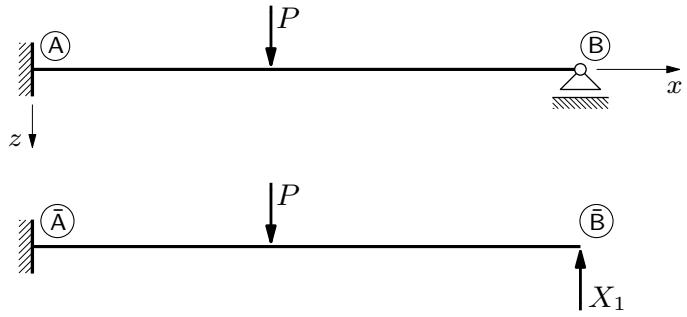
Umjesto zadane jednostrano upete grede  $\bar{A}\bar{B}$  uvest ćemo konzolu  $\bar{A}\bar{B}$  istoga raspona  $\ell$  i istih geometrijskih i materijalnih karakteristika  $EI$ , opterećenu silom  $\vec{P}$  u istom položaju te silom  $\vec{X}_1$ , zasad nepoznate vrijednosti  $X_1$ , na pravcu koji odgovara pravcu djelovanja reakcije  $\vec{R}_B$ . Sila  $\vec{X}_1$  zamjenjuje reakciju  $\vec{R}_B$ , a time i ležaj  $B$  jednostrano upete grede.
