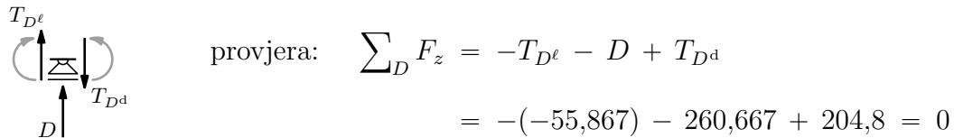
vrijednosti unutarnjih sila u karakterističnim točkama (izravno izračunavanje):
