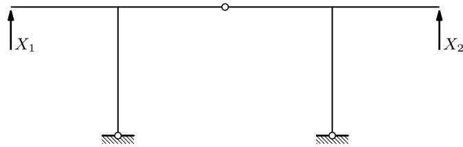
Razmijerno poznati bi osnovni sistem mogao biti i trozglobni okvir s dvije „jednostavno oslonjene grede” kojima su nepomični zglobni „ležejevi” zglobni spojevi s okvirom:
