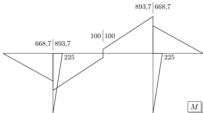
**2.3.** Relativni kut zaokreta između osi grede neposredno desno od točke A i osi grede neposredno lijevo od točke B:
