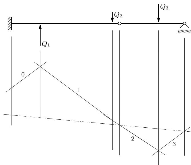
Na zadatu Gerberovu nosaču moment iščezava u desnome ležaju i u zglobu. Momentni je dijagram parabola trećega stupnja,
