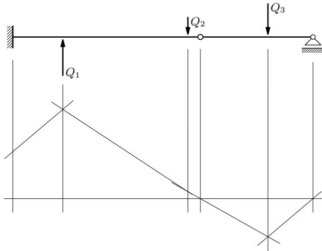
Od horizontalne osi na vertikalne pravce nanosimo na prethodnom crtežu izmjerene duljine odsječaka vertikalnih pravaca između vrhova verižnoga poligona i točaka na zaključnoj liniji.
