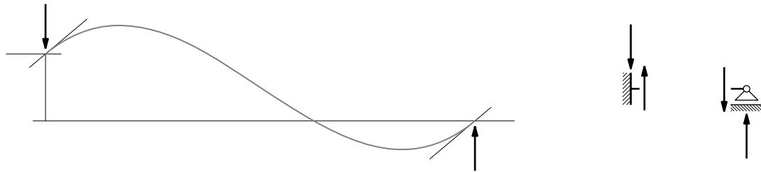
Između lijevoga ležaja i polovine raspona moment poprima najveću (apsolutnu) vrijednost. U toj je točki tangenta na krivulju momentnoga dijagrama horizontalna (nagib joj je nula), pa poprečna sila iščezava, što znači da krivulja dijagrama poprečnih sila siječe apscisnu os. Vrijednost poprečne sile u polovini raspona stoga ima suprotan predznak od vrijednosti neposredno uz ležaj — vrijednost je pozitivna, pa je nanosimo ispod osi.
